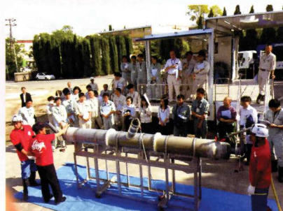
写真-2 透明素材の模擬管 に裏込め材を注入
